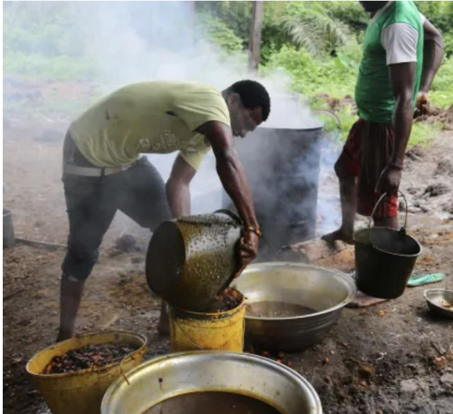
Buah sawit itu direbus, agar daging buah nya melunak , lalu diperas dengan alat yang tradisional untuk dapatkan M.Sawit
