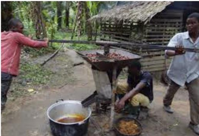
Buah sawit itu direbus, agar daging buah nya melunak , lalu diperas dengan alat yang tradisional untuk dapatkan M.Sawit
